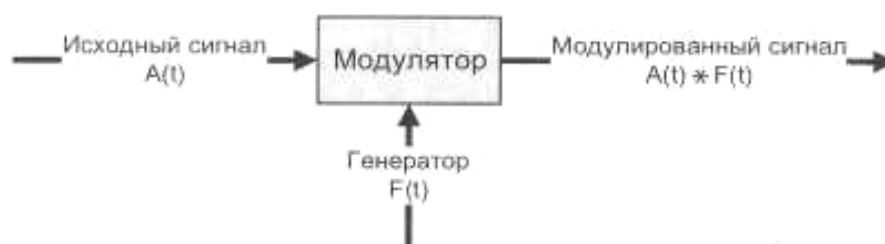
Рисунок 1 - Принцип работы аналогового модема
